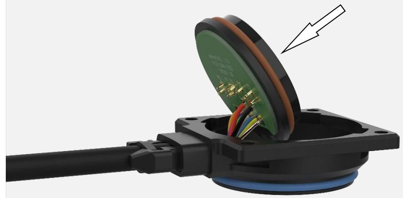
FIT SEAL OVER SPRING CONTACTS, PUSH THE SEAL ALL THE WAY DOWN TO THE PCB, MAKING SURE IT IS ENTIRELY FLAT.
